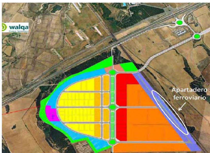
Figura 21. Planta de la plataforma PLHUS y posición de su apartadero ferroviario.
