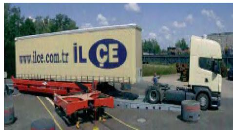
Los vagones para el ferrouatge tienen una plataforma extra-baja sobre ruedas de pequeño diámetro (36 cm) que permiten con el camion encima (de 4,00 m de altura y 2,60 m de ancho) mantenerse dentro los gálidos del transporte ferroviario.
